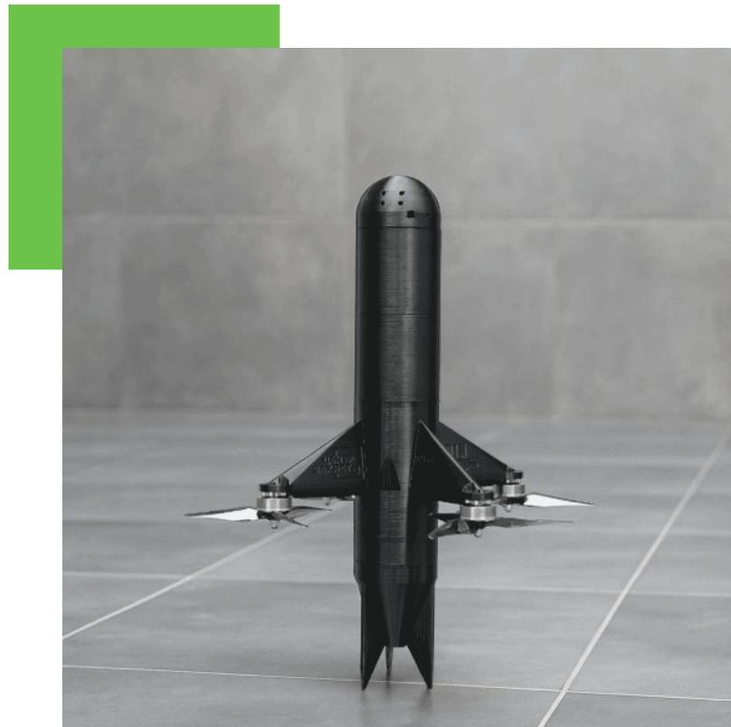
Hochgeschwindigkeits-ODIN Win\_Hit FPV-Abfangdrohne in vertikaler Startkonfiguration, entwickelt, um feindliche Drohnen im Flug abzufangen, [↗ Militarnyi, 16.7.2025](#)
